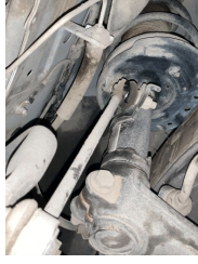
Direksiyon sistemi, Rot kolu/Rot başı, sol > Hasarlı
