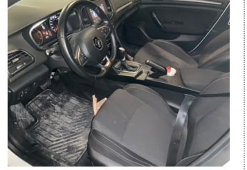
Döşemeler/Kapaklar, Döşemeler/Kapaklar > Kirlenmiş
