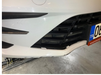
Tampon, ön, Ön tampon ızgarası > Sabitlemesi Hatalı
