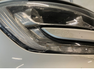
Farlar, Far camı, sağ > Çatlak
