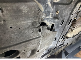
Motor, Alt muhafaza > Hasarlı
