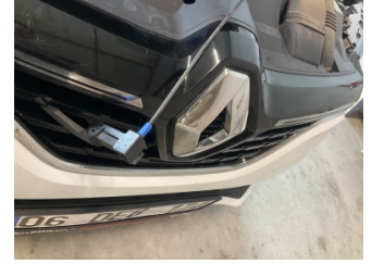
Motor kaputu, Açma Mandalı Dış > Hasarlı
