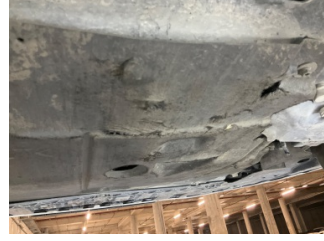
Motor, Alt muhafaza > Hasarlı
