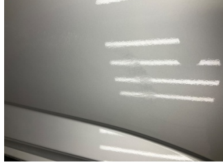
Kapı, sağ ön, Kapı, sağ ön > Deforme Olmuş
