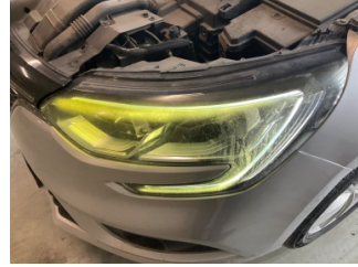
Farlar, Far camı, sol > Deforme Olmuş
