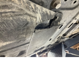
Motor, Alt muhafaza > Hasarlı
