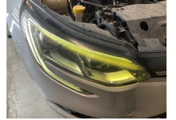
Farlar, Far camı, sağ > Deforme Olmuş
