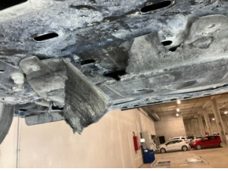
Motor, Alt muhafaza > Hasarlı
