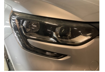
Farlar, Far camı, sağ > Deforme Olmuş
