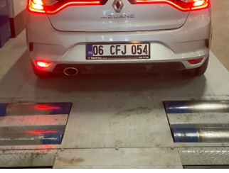
Tampon, arka, Reflektör, sağ > Arızalı
