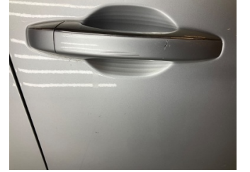
Kapı, sağ ön, Kapı, sağ ön > Çizik
