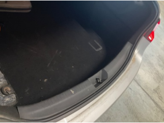
Döşemeler/Kapaklar, D-direk iç kaplaması, sol > Çizik
