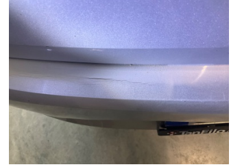
Tampon, arka, Arka tampon > Çatlak
