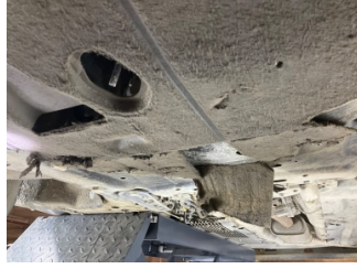
Motor, Alt muhafaza > Hasarlı
