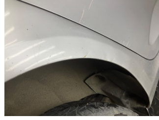
Çamurluk, sağ arka, Çamurluk, sağ arka > Ezik
