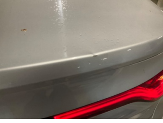
Bagaj kapağı/kapısı, Bagaj kapısı > Ezik
