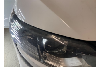
Farlar, Far camı, sağ > Deforme Olmuş
