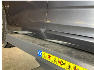
Marşbiyel, sağ, Marşbiyel, sağ > Hasarlı
