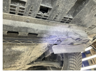
Tampon, ön, Tampon koruyucu orta > Deforme Olmuş
