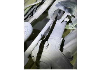
Direksiyon sistemi, Rot kolu/Rot başı, sol > Hasarlı
