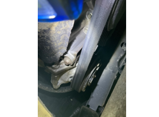
Motorsoğutması, Kayış > Deforme Olmuş
