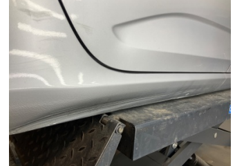
Marşbiyel, sağ, Marşbiyel, sağ > Hasarlı
