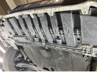
Kaporta, Muhafaza, orta > Hasarlı
