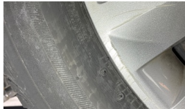
Tekerlek seti > Çatlak
