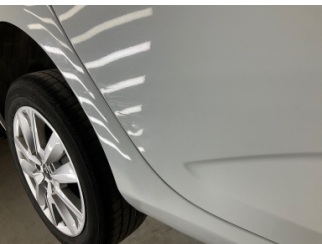
Kapı, sağ arka, Kapı, sağ arka > Ezik
