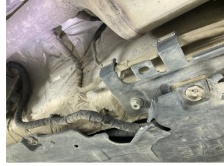
Kaporta, Muhafaza, orta > Hasarlı
