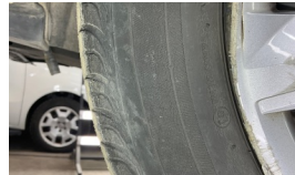
Tekerlek seti > Çatlak
