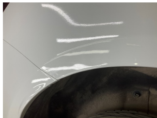
Çamurluk, sağ arka, Çamurluk, sağ arka > Ezik
