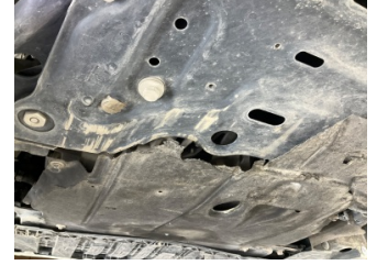
Kaporta, Muhafaza, orta > Hasarlı
