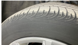
Tekerlek seti > Çatlak
