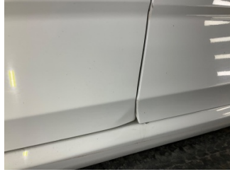
Kapı, sol ön, Kapı, sol ön > Ezik
