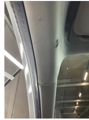
Döşemeler/Kapaklar, Döşemeler/Kapaklar > Yakıcı Madde Ile Zarar Görmüş
