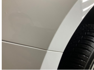
Çamurluk, sol, Çamurluk, sol > Rötüş
