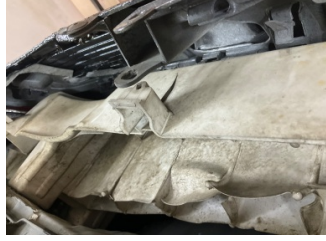
Tampon, arka, Bağlantı ayağı > Hasarlı
