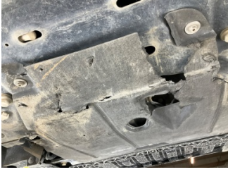
Motor, Alt muhafaza > Hasarlı
