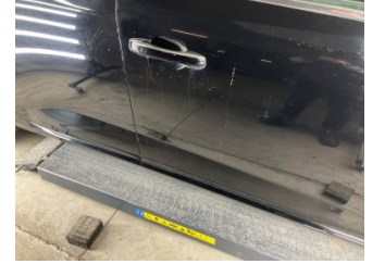
Kapı, sağ ön, Kapı, sağ ön > Çizik
