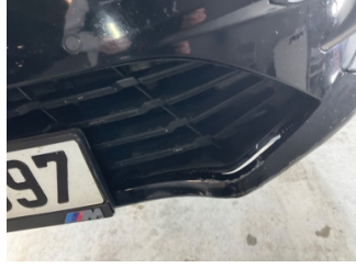
Tampon, ön, Ön tampon ızgarası > Sabitlemesi Hatalı
