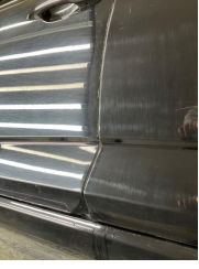
Kapı, sol ön, Kapı, sol ön > Ezik
