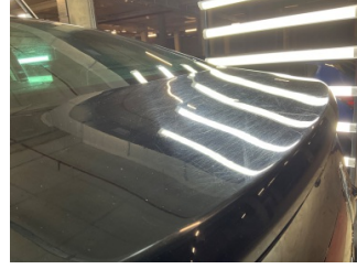
Bagaj kapağı/kapısı, Bagaj kapısı > Noktasal Ezik
