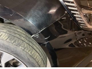
Tampon, ön, Ön tampon > Sabitlemesi Hatalı
