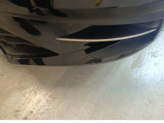
Sis lambaları, Sis Izgarası Sol > Sabitlemesi Hatalı
