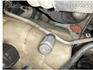
Motorsoğutması, Soğutma sıvısı > Eksik
