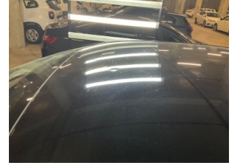
Tavan, Tavan > Dolu Hasarı
