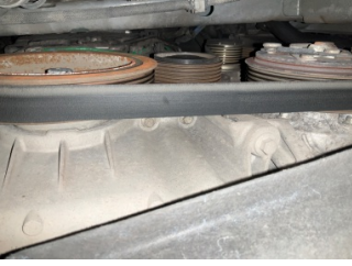
Motorsoğutması, Kayış > Deforme Olmuş
