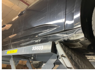
Marşbiyel, sağ, Marşbiyel, sağ > Hasarlı
