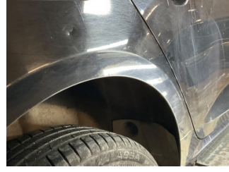
Çamurluk, sağ arka, Çamurluk, sağ arka > Ezik
