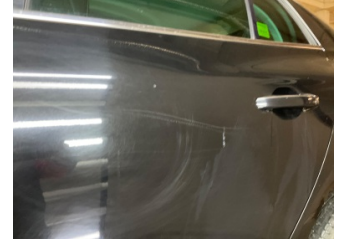
Kapı, sol arka, Kapı, sol arka > Çizik
