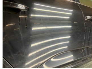
Kapı, sağ arka, Kapı, sağ arka > Çizik
