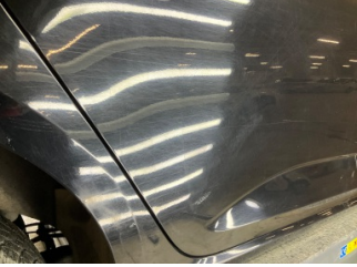
Kapı, sağ arka, Kapı, sağ arka > Çizik
