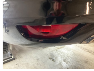
Tampon, arka, Reflektör, sol > Hasarlı
