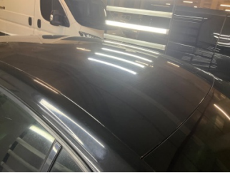
Tavan, Tavan > Dolu Hasarı
