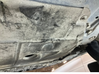
Motor, Alt muhafaza > Hasarlı
