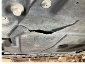
Motor, Alt muhafaza > Hasarlı
