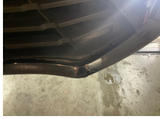
Tampon, ön, Ön tampon ızgarası > Sabitlemesi Hatalı
