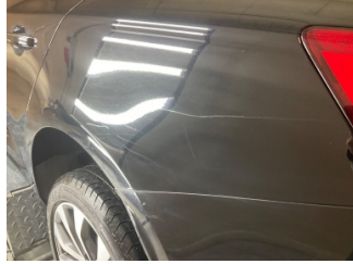
Çamurluk, sol arka, Çamurluk, sol arka > Çizik
