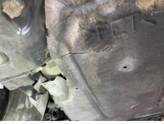
Motor, Alt muhafaza > Hasarlı
