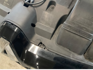
Tampon, ön, Tampon koruyucu orta > Hasarlı
