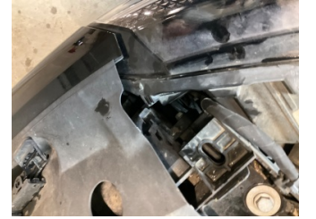
Farlar, Far bağlantı ayağı, sağ > Hasarlı
