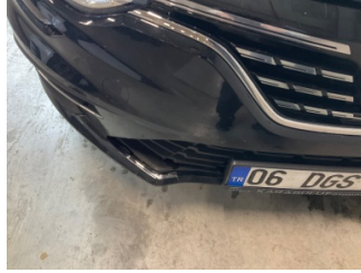
Tampon, ön, Ön tampon ızgarası > Sabitlemesi Hatalı
