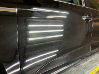
Kapı, sol ön, Kapı, sol ön > Çizik
