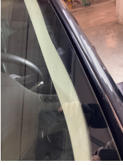
Döşemeler/Kapaklar, A-direk iç kaplaması, sol > Sabitlemesi Hatalı
