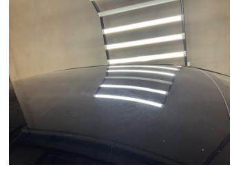
Tavan, Tavan > Dolu Hasarı
