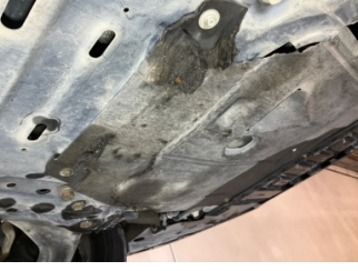
Motor, Alt muhafaza > Hasarlı
