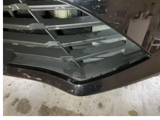
Tampon, ön, Ön tampon ızgarası > Sabitlemesi Hatalı
