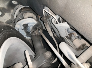
Direksiyon sistemi, Rot kolu/Rot başı, sağ > Hasarlı
