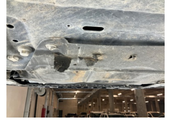
Motor, Alt muhafaza > Hasarlı
