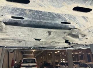
Motor, Alt muhafaza > Hasarlı
