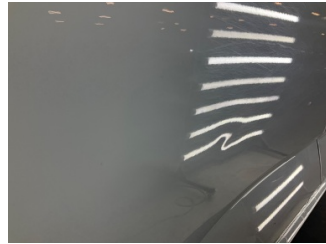
Kapı, sağ arka, Kapı, sağ arka > Ezik
