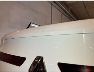
Bagaj kapağı/kapısı, Bagaj kapısı > Ezik
