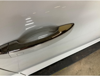
Kapı, sağ ön, Kapı kolu, dış > Boyası Atmış
