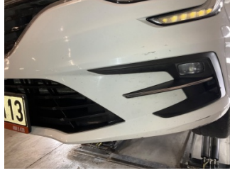
Tampon, ön, Ön tampon ızgarası > Sabitlemesi Hatalı
