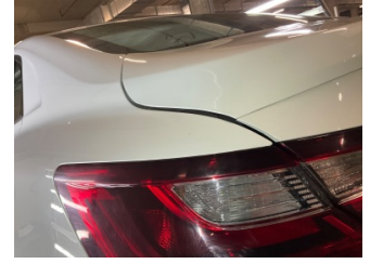
Bagaj kapağı/kapısı, Bagaj kapısı > Hatalı Ayarlanmış
