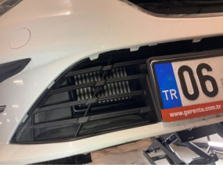
Tampon, ön, Ön tampon ızgarası > Sabitlemesi Hatalı
