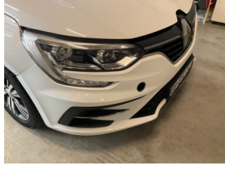
Tampon, ön, Çeki demir kapağı > Sökülmüş-Yok
