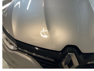
Motor kaputu, Motor kaputu > Hasarlı
