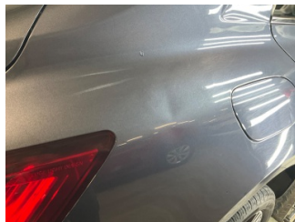
Çamurluk, sağ arka, Çamurluk, sağ arka > Ezik
