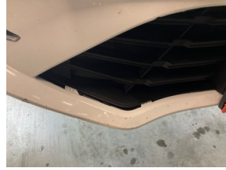
Tampon, ön, Ön tampon > Sabitlemesi Hatalı
