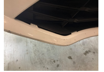
Tampon, ön, Ön tampon > Çatlak
