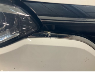
Tampon, ön, Ön tampon ızgarası > Çatlak
