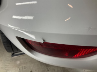
Tampon, arka, Arka tampon > Çatlak
