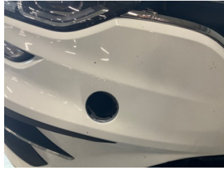
Tampon, ön, Çeki demir kapağı > Sökülmüş-Yok
