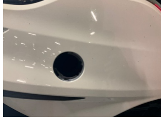
Tampon, ön, Çeki demir kapağı > Sökülmüş-Yok
