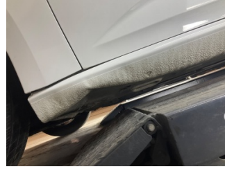
Marşbiyel, sol, Marşbiyel, sol > Hasarlı
