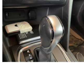
Şanzıman, Vites topuzu > Deforme Olmuş
