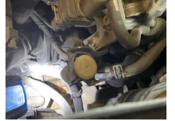
Motor, Motor > Yağ Kaçağı
