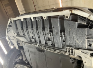
Tampon, ön, Tampon koruyucu orta > Hasarlı
