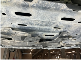
Motor, Alt muhafaza > Hasarlı
