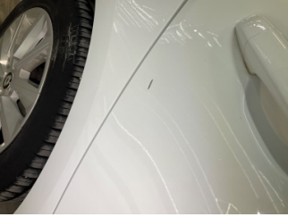
Kapı, sağ arka, Kapı, sağ arka > Çizik
