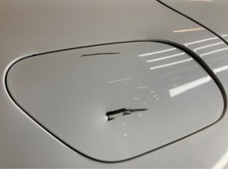
Çamurluk, sağ arka, Yakıt deposu kapağı > Hasarlı
