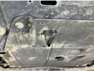
Motor, Alt muhafaza > Hasarlı
