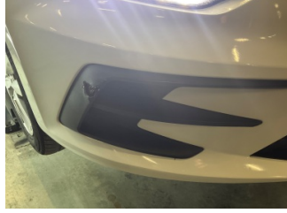
Sis lambaları, Sis Izgarası Sağ > Hasarlı
