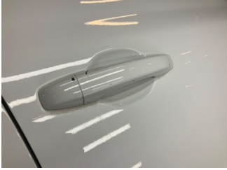
Kapı, sağ ön, Kapı kolu, dış > Çizik
